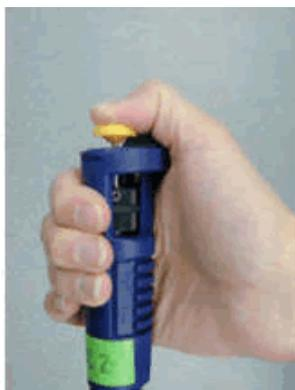
5 – Coloque a extremidade da ponta dentro do líquido
